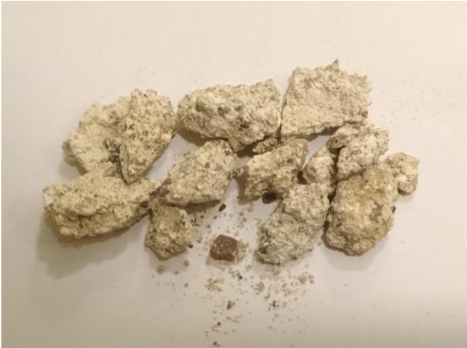
10 pav. a) III-čias skliautas priekis, šviesus (pirmas) tinko sluoksnis. Bendras vaizdas
