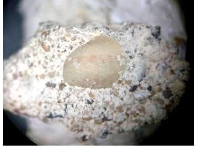
10 pav. b) III-čias skliautas priekis, šviesus (pirmas) tinko sluoksnis. Vaizdas pro mikroskopą, x25
